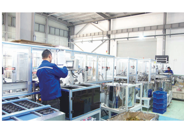
安徽九池智能安防科技有限公司落户集中区以来,专注于智能锁及智能家居设备的研发、制造、加工及销售工作,发展势头向好,去年该公司产值达到3亿元。今年,该公司进一步升级自动化生产设备,产能有望实现翻倍增长,目前正在积极推进上市事宜。图为该公司整锁自动装配包菜线。 记者 鲍勇 摄
