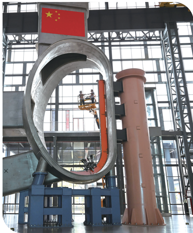
2023年9月15日，工作人员在聚变堆主机关键系统综合研究设施(CRAFT)1/8真空室及总体安装实验平台进行设备调试。 新华社记者 周牧 摄
